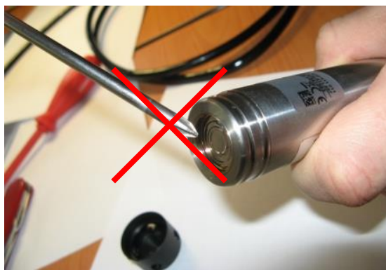
Obr. 62 Špatné čištění sondy
