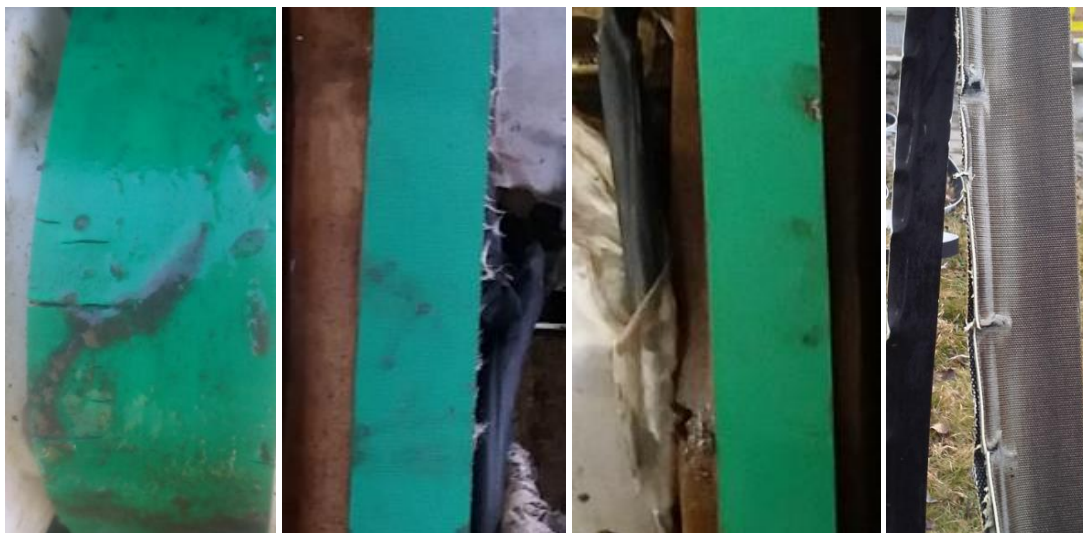
Obr. 50 Poškozený pás pohonu
