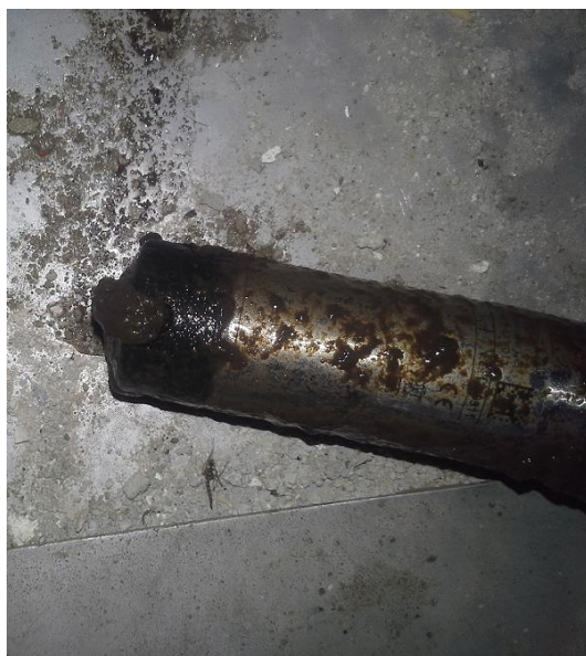
Obr. 48 Špinavá tlaková sonda
