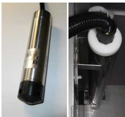
Obr. 18 Tlaková sonda (detail, v kalové jímce)
