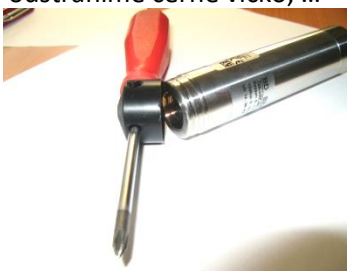
Obr. 61 Správné čištění tlakové sondy
