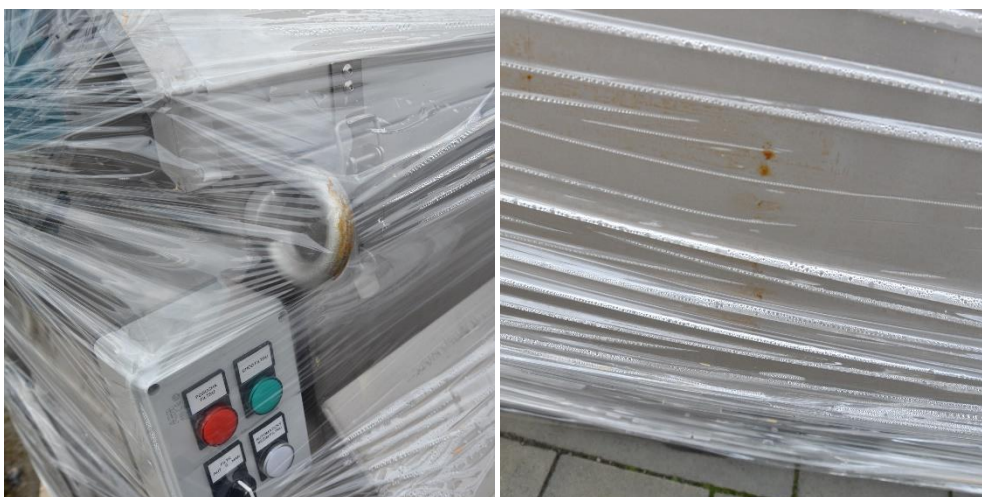
Obr. 39 Nevhodné balení pro dlouhodobé skladování
