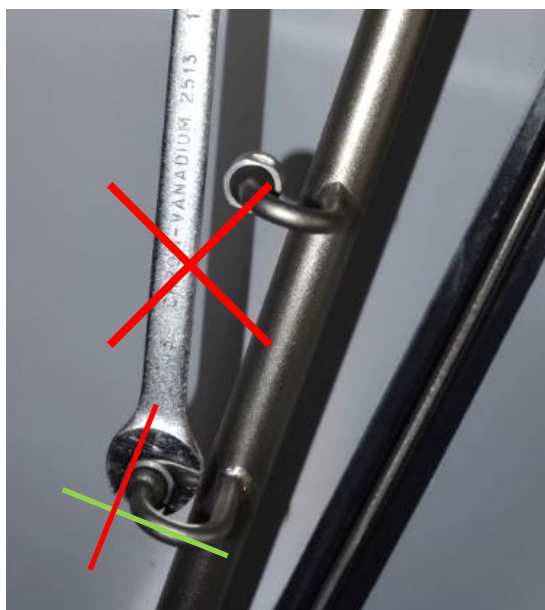
Obr. 58 Chybné natočení trysky (viz pozice klíče)
