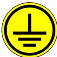
Obr. 12 Hlavní zemnicí bod - označení
