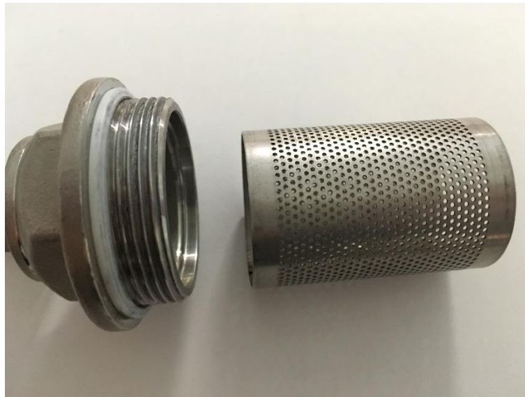
Obr. 35 Důkladné čištění sítko filtru do potrubí
