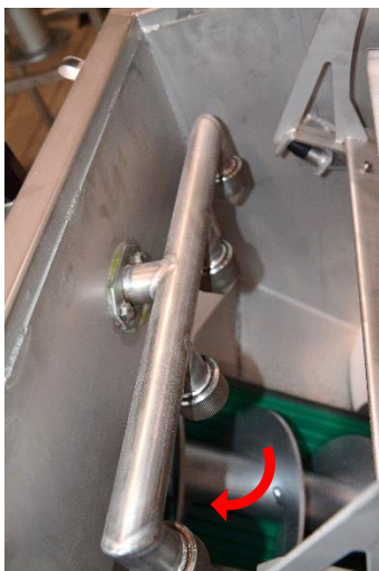
Obr. 23 Směr otáčení vynášecího šneku a vymetání česlí
