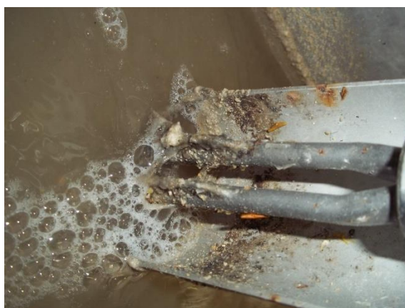
Obr. 31 Zanesená limitní vibrační sonda
