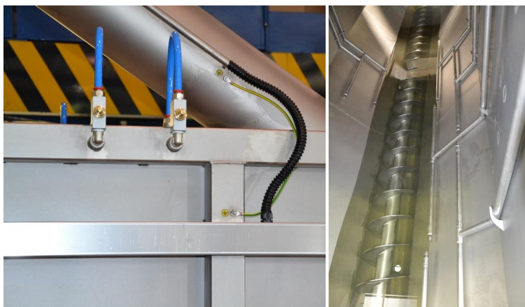
Obr. 14 MZG s provzdušněním
