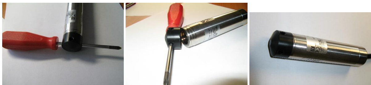
Obr. 41 Správné čištění tlakové sondy
