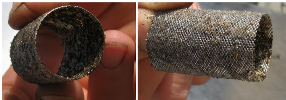
Obr. 40 Zanesený filtr do potrubí
