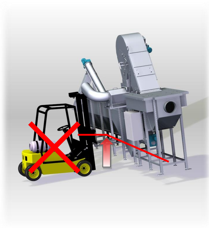
Obr. 26 Nemanipulujte se zařízením pomocí vysokozdvizného vozíku!
