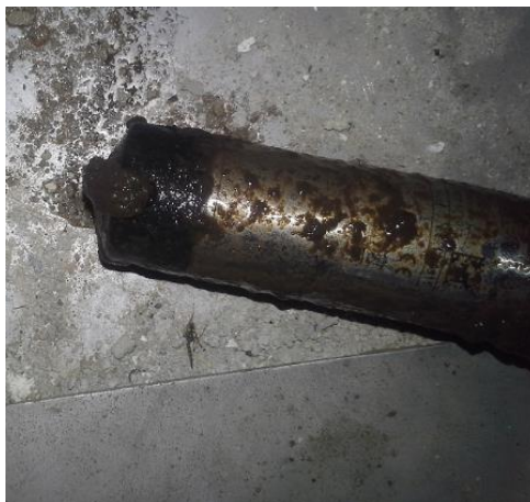
Obr. 39 Zanesená tlaková sonda
