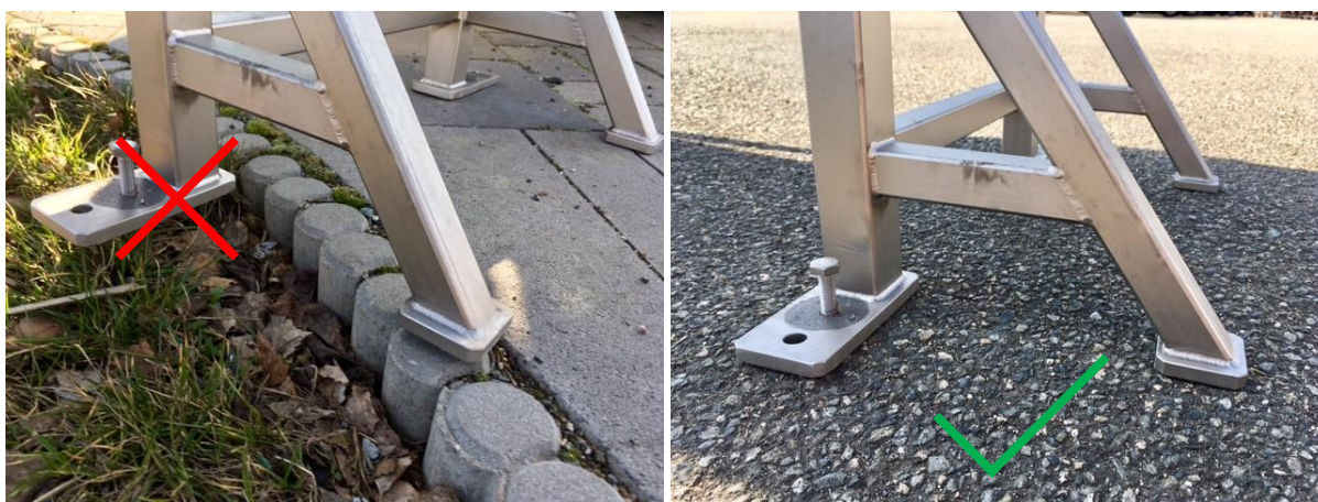
Obr. 29 Nevhodná a vhodná instalace zařízení
