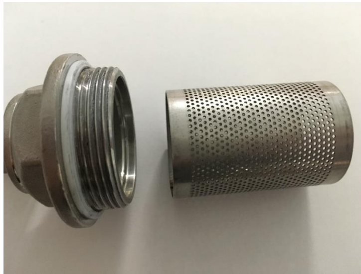
Obr. 46 Důkladné čištění sítko filtru do potrubí
