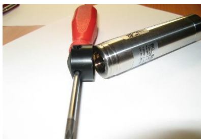
Obr. 19 Správné čištění tlakové sondy
