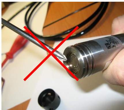
Obr. 20 Špatné čištění sondy
