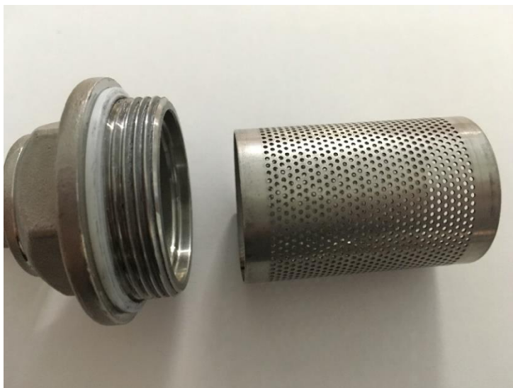
Obr. 37 Důkladné čištění sítko filtru do potrubí
