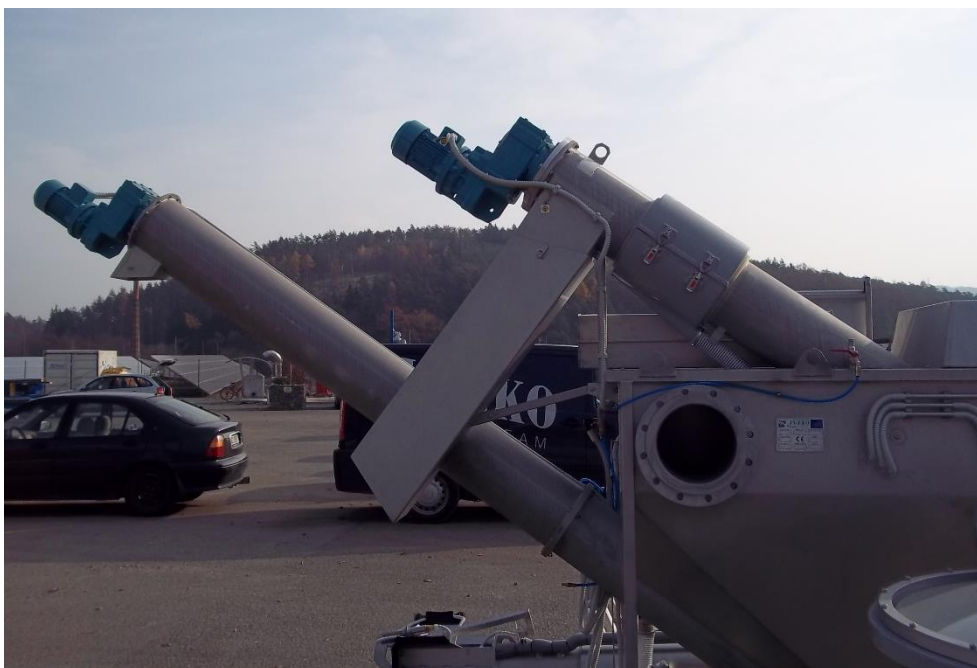
Obr. 7 MZ s odvodněním shrabků
